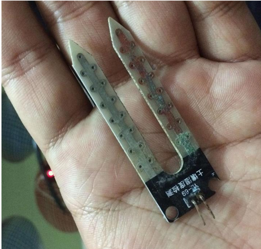
ภาพที่ 3: แสดงการถูกกัดกร่อนและขึ้นสนิมที่หัววัดแผง PCB สำหรับเสียบลงดิน
